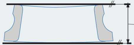
Minsta omskrivna storlek mellan två parallella plan som är associerade till de verkliga ringytorna
