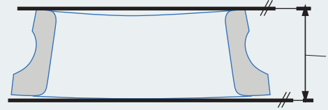
Kleinstes umschriebenes Größenmaß zwischen zwei parallelen Ebenen, die an den realen Ringseitenflächen assoziiert sind
